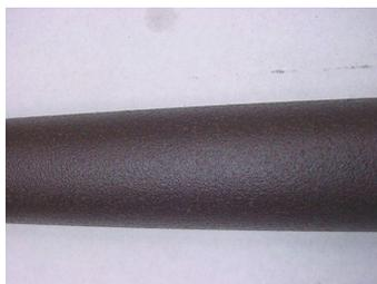
Bei der modernen *Industrie*-Serie wird der Rostcharakter der Rohrgestelle sogar durch Wachsen und ein nachträglich aufgetragenes Öl unterstrichen. So entstehen gerostete Oberflächen, die der Kollektion einen modernen, urbanen Akzent verleihen.
